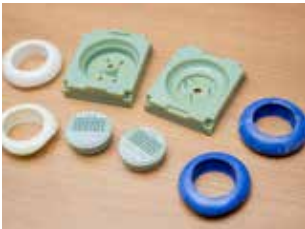
デジタルモールド（後ろ中央）と成形した部品（左右）、J850 による試作（手前中央）
