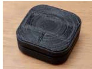
社内導入している FDM 方式 3D プリンタ F270 にて構造検討をした ABS 樹脂のタイマーとスイッチ部分
